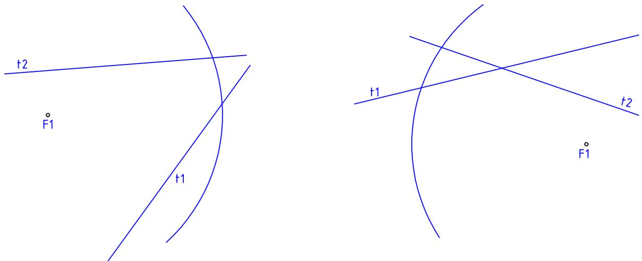
11.-DETERMINAR LOS EJES PRINCIPALES DADOS UNA TANGENTE, EL PUNTO DE TANGENCIA, UN FOCO Y LA DIRECCION DEL EJE MAYOR
