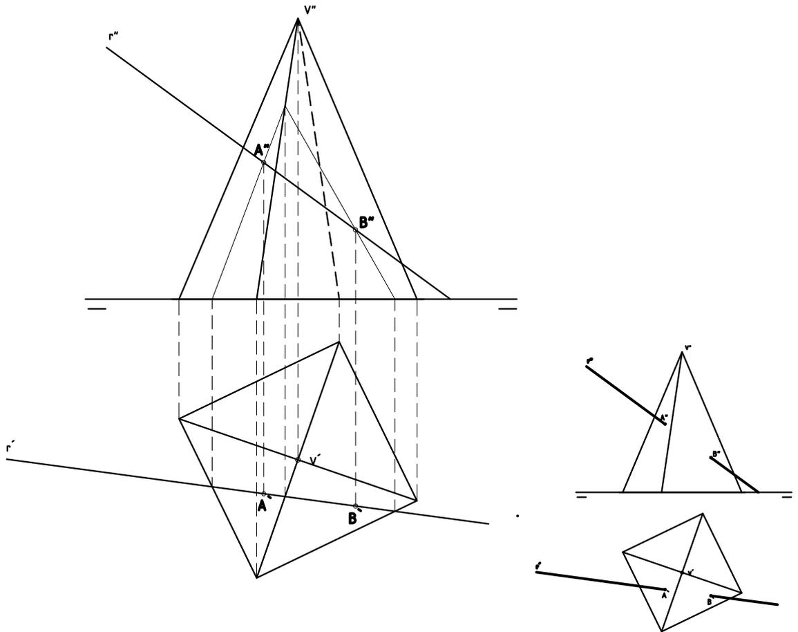
HALLAR LOS PUNTOS DE INTERSECCION DE LA RECTA  $r(r'',r')$  CON EL PRISMA DADO.
