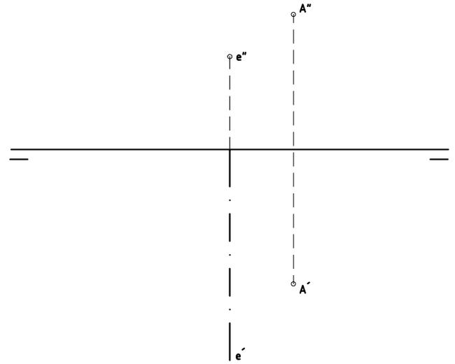
3.-DIBUJAR LAS PROYECCIONES HORIZONTAL Y VERTICAL DEL PUNTO A DESPUES DE GIRARLO 90° (EN EL SENTIDO HORARIO, VISTO DESDE ARRIBA) ALREDEDOR DEL EJE e(e'', e')
