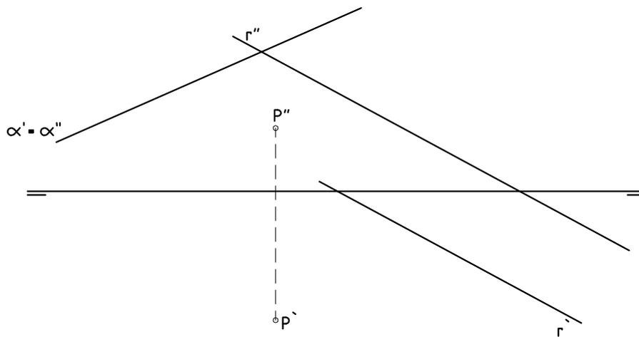
CONOCEMOS LA TRAZA HORIZONTAL Y LA TRAZA VERTICAL ABATIDA DE UN PLANO ALFA. HALLA SU TRAZA VERTICAL ASI COMO LAS PROYECCIONES DE UN CUADRILÁTERO ABCD CONTENIDO EN ALFA, SABIENDO QUE EL LADO BC ESTA EN EL PLANO VERTICAL Y MIDE 12 mm Y QUE EL LADO DA ESTA EN EL PLANO HORIZONTAL Y MIDE 24 mm.
