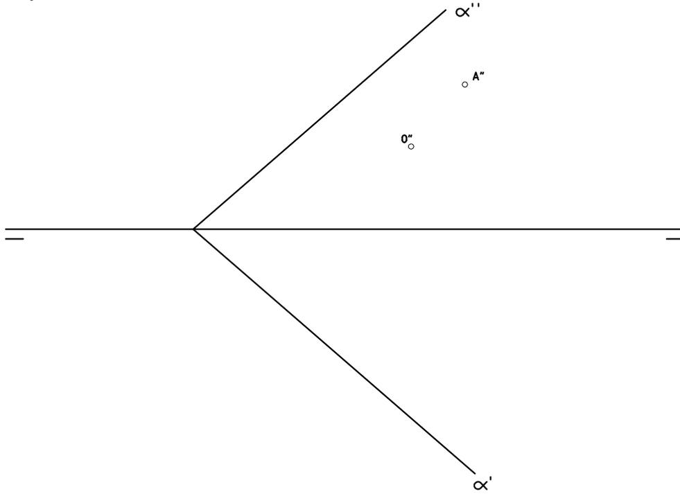
DIBUJAR LAS PROYECCIONES HORIZONTAL Y VERTICAL DE UN CUADRADO CONTENIDO EN EL PLANO DADO SIENDO LOS PUNTOS O y A EL CENTRO Y UN VERTICE RESPECTIVAMENTE.
