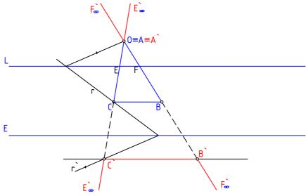
1.-Se dibuja la recta r que pasa por C 2.-Por C' se traza una paralela al eje obteniendose la homologa de BC 3.-A' coincide con A y con O.
