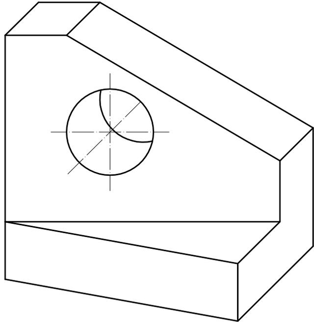
DIBUJA A ESCALA 3:2, LA PERSPECTIVA ISOMETRICA DE LA PIEZA DADA POR SUS VISTAS REPRESENTADAS A ESCALA NATURAL. NO TENGAS EN CUENTA EL COEFICIENTE DE REDUCCION ISOMETRICO. COMPLETA SU PERFIL IZQUIERDO.
